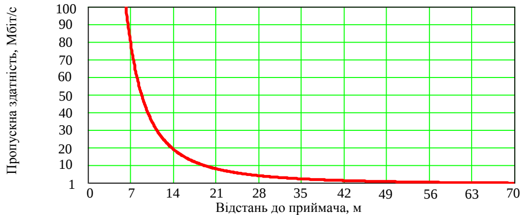
Рис. 1. Залежність швидкості передавання MIMO системи в стандарті IEEE 802.11n (потужність передавача складає 17 дБм) від відстані
